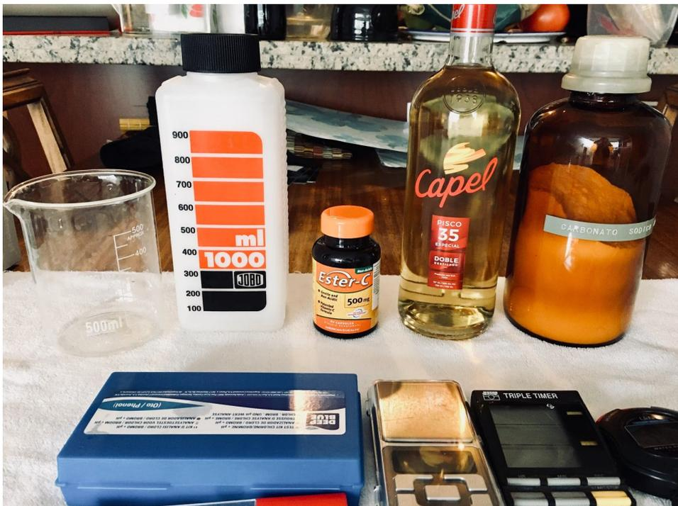
En una primera etapa de experimentación realizamos medición del pH del píscol, el cual dio un pH naranja (pH 6 aprox) y también lo medimos una vez agregado el carbonato de sodio, el que detonó un color verde (pH 10 a 12 aprox). El color verdoso corresponde a un valor de pH más alcalino (por efecto del carbonato sódico, sustancia de reacción alcalina que aumenta la velocidad del revelado).
